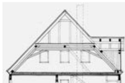
Obr. B-175 Náčrt krovu s ležatou stolicí, obec Cunewalde / Obr. B-176 Latě vložené mezi krokve podírají podkladové bednění pro břidlicovou krytinu (Foto: St. Freitag)
