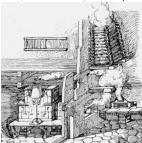
Obr. D-2 (vlevo): Situace před nístějí: „Otopné zařízení jednoho lužického obytného domu (obec Ralbitz bei Königs-Warthe)“ 151
