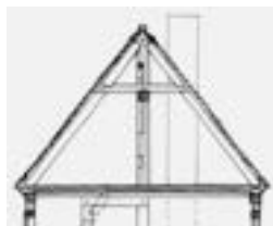
Obr. B-174 Náčrt krovu s vaznicí pod hambálky, podepřený sloupky, obec Crostwitz
