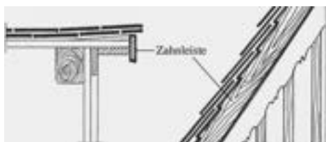
Obr. C-10 Šupinové krytí Radzimów (PL) / korunové krytí Schöna (D)
