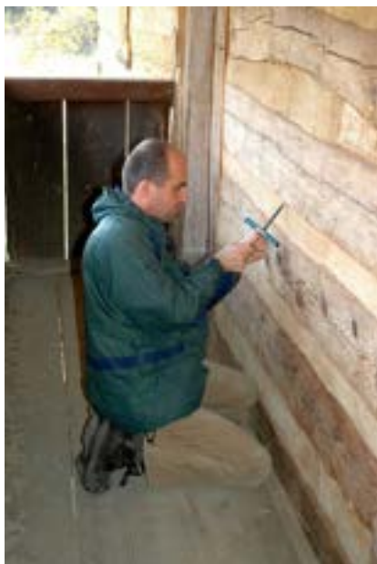
Obr. F-7 Odběr vzorku dřeva pro dendrochronologické datování.
