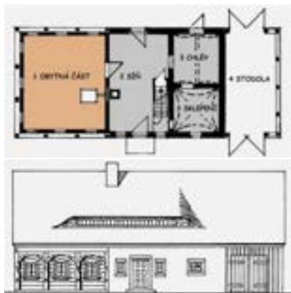
Obr. B-57 Přízemní dům chlévního typu, půdorys a pohled, nákres dle R. Andera
