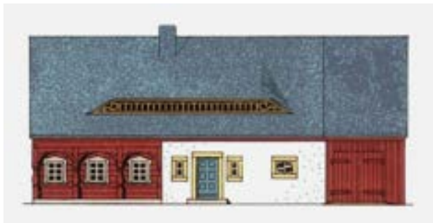
Obr. E-5 Čtyřdílný přízemní podstávkový dům z „Ander, R. (1982). Merkmale für Denkmalpflege . Dresden: Helbig, Jochen, Památkový ústav, pracoviště Dresden“
